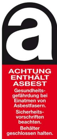
Asbest wird durch die Gefahrstoffverordnung (GefStoffV) in Gefährdungsgruppe 1 (höchste Gefährdungsgruppe !) "krebserzeugend" eingestuft. Der Umgang mit Asbest wird durch die Gefahrstoffverordnung (GefStoffV) und die TRGS 519 (Technische Regeln Gefahrstoffe) geregelt.
