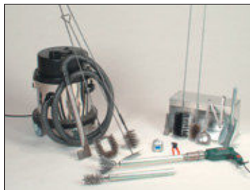
Abb. 13: Utensilien zur Reinigung des Kessels
