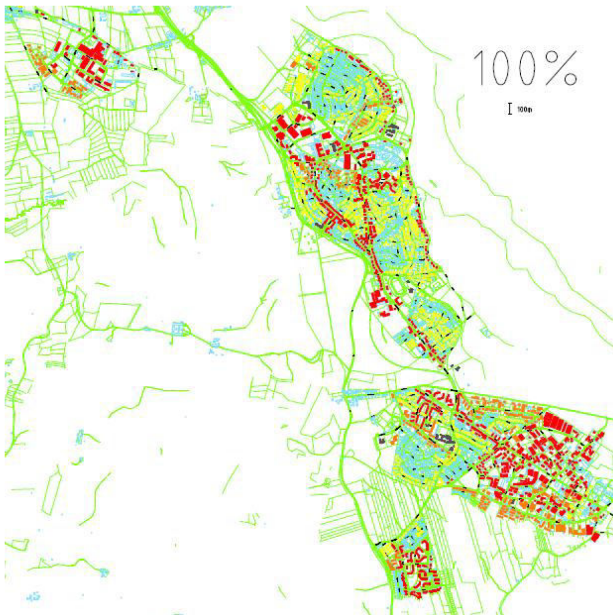
Abbildung 24: Beispiel eines Wärmekatasters
