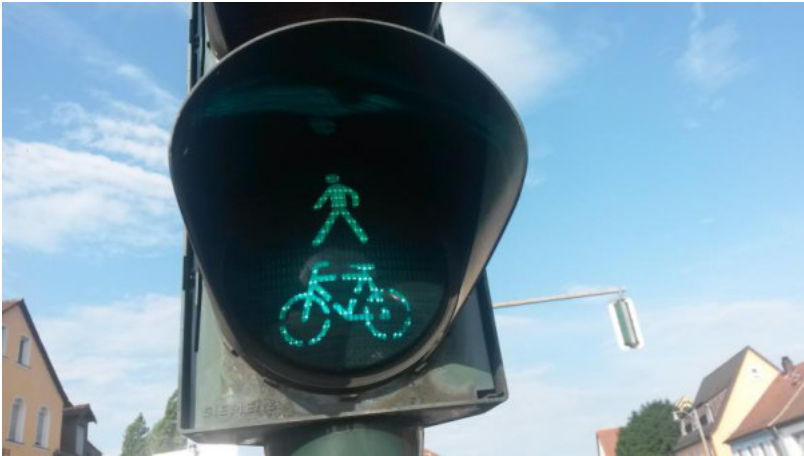
Abb. 83: Bei der gemeinsamen Signalisierung von Fuß- und Radverkehr verlängert sich die Rotphase für Fahrradfahrerinnen unnötig. Eine Alternative sind eigene Ampeln (Signalgeber) für den Radverkehr.
