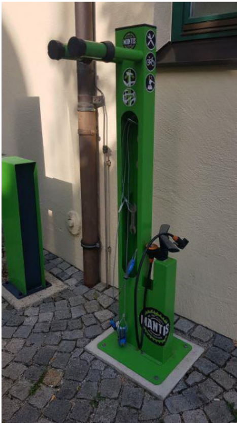
Abb. 89: Servicestation mit Luftpumpe, Werkzeug und Aufhängemöglichkeit des Fahrrads
